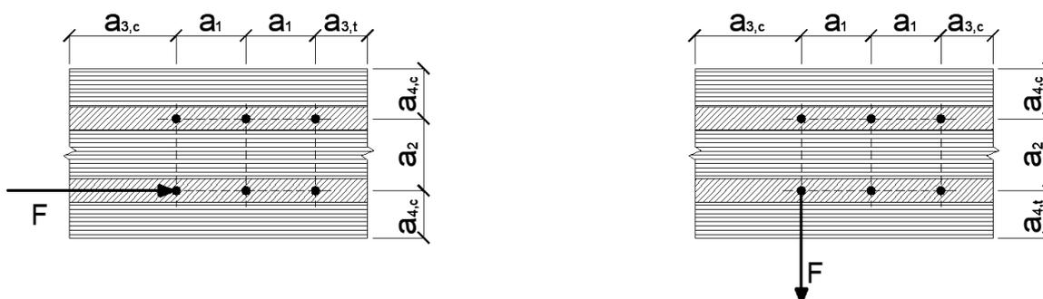
A.2.2 Definition der Mindestabstände in den Schmalflächen des Brettsperrholzes. Bei Schrauben in den Schmalflächen sind die Abstände  $a_1$  und  $a_3$  parallel zur Seitenfläche sowie die Abstände  $a_2$  und  $a_4$  rechtwinklig zur Seitenfläche des Brettsperrholzes
